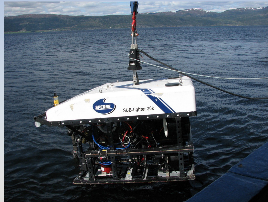
En fjernstyrt undervannsfarkost (ROV) senkes ned i Trondheimsfjorden. Foto: Svein Karlsen
